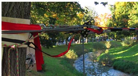
Kraftmessdose im Highline-Aufbau
